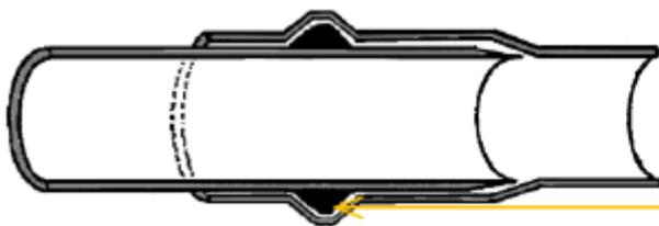
Joint ou bague d'étanchéité en élastomère
